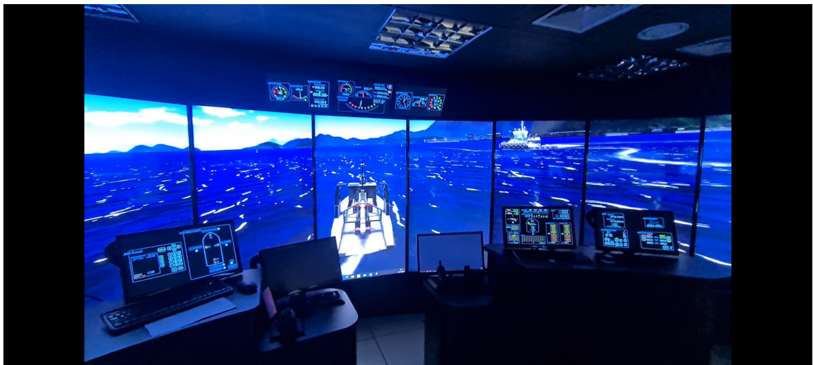
Figura 48: Simulação no TPN testando o algoritmo de prevenção de colisão
